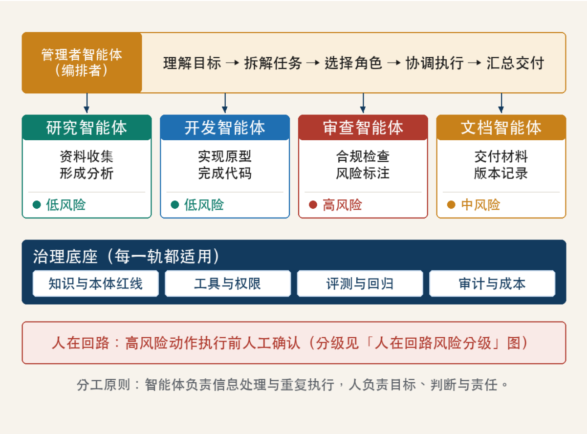
图 19：多智能体协作架构：管理者—工作者分层，复杂任务拆分为专业子任务，人在关键节点确认
