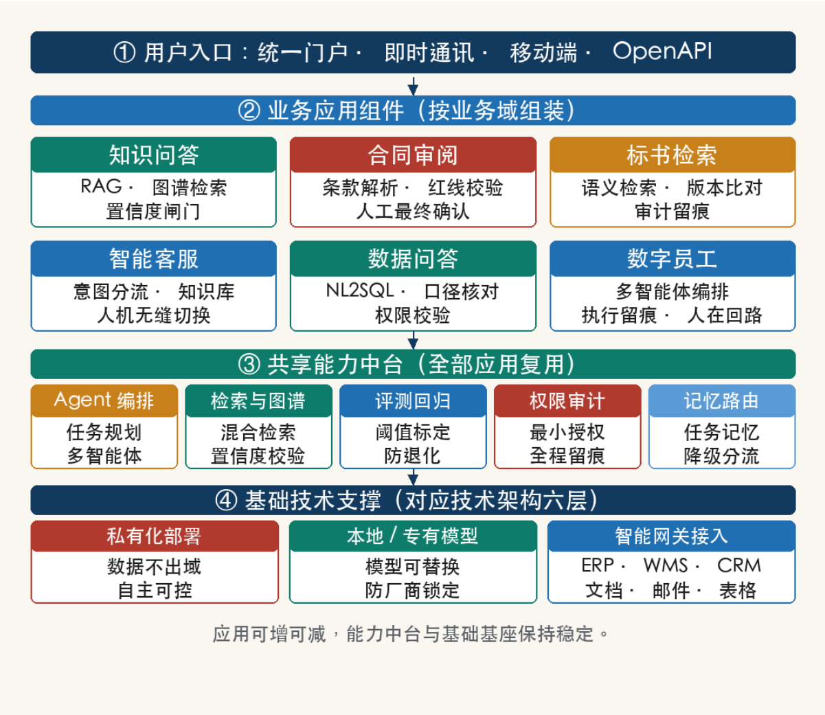
图 5：应用架构：用户入口 → 业务应用组件 → 共享能力中台 → 基础技术支撑，应用可增可减、中台与基座保持稳定
